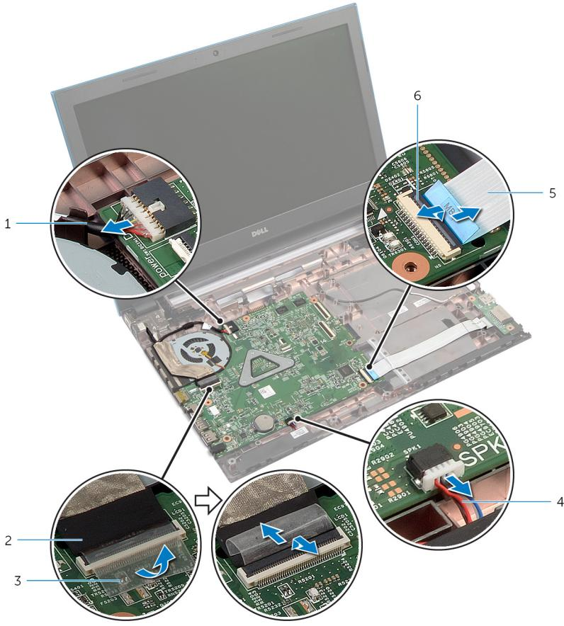
**1** kabel priključka adaptera za napajanje      **2** kabel zaslona
